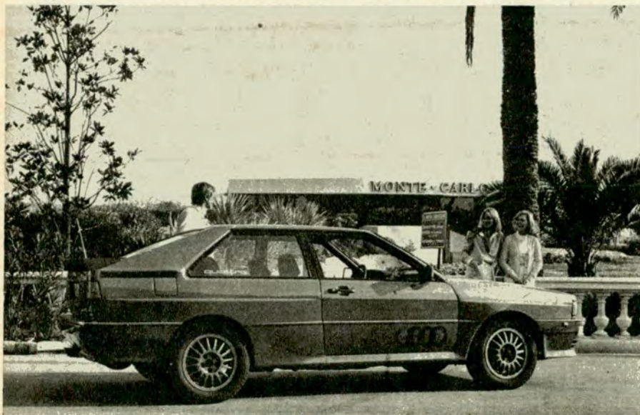
Este es el modelo superdeportivo Audi Quattro, dotado de doble tracción constante y además de un revolucionario motor turboalimentado y postenfriado de 200 CV.
